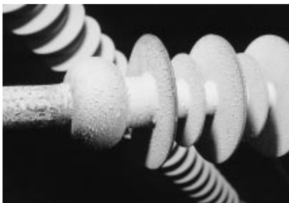
写真 7 IEC 61109 試験 5000 時間後のがいし表面 Insulator surface after 5000 hours of IEC 61109 Annex C test
