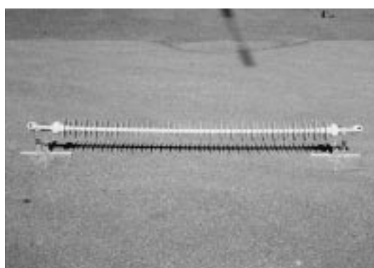
写真1 供試複合がいし Test composite insulator
