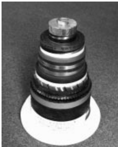
写真1 海底ケーブルの外観 Appearance of the submarine cable
