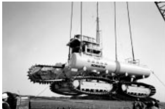
写真7 岩盤掘削機 (通称 岩掘号) Rock trencher
