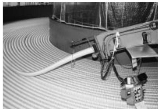
写真2 大型乾燥油浸釜へのケーブルコア巻き込み Storing the cable core to a large kettle for oil impregnation after drying
