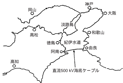
図1 ケーブルルート Route of submarine cables
