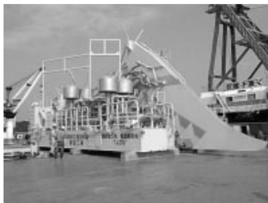
写真5 ウォータージェット付加型鋤式埋設機（通称 ホール号） Plow type high speed embedding machine with water jet
