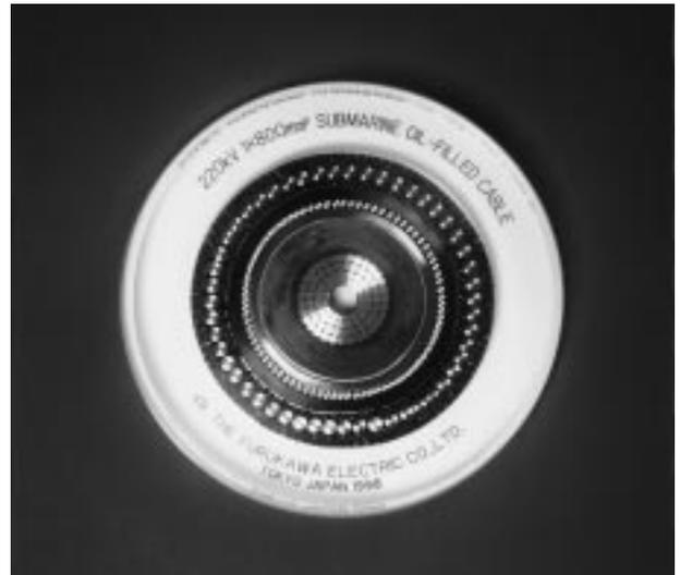
写真1 一重鉄線鎧装 220 kV  $1 \times 800 \text{ mm}^2$  OF ケーブル
