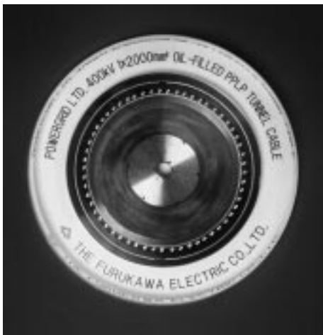
写真1 ケーブル構造断面 Cross-section of 400-kV OFLTAZV 1 × 2000 mm 2
