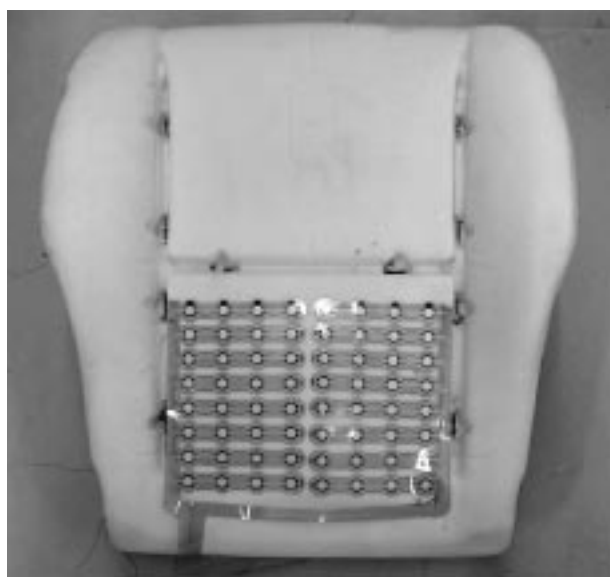
写真1 感圧フィルムセンサの設置状況 Installation of distributed tactile force sensor mat
