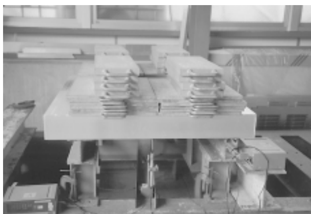
写真2 エコ - ア・パレットのたわみ試験 Deflection tests of ECO-A pallet
