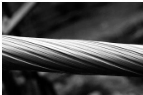
図17 金車通過後の低風音低風圧電線 Surface of LNP810 after pulling test
