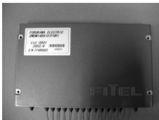
図14 OADMモジュール外観 Appearance of OADM module
