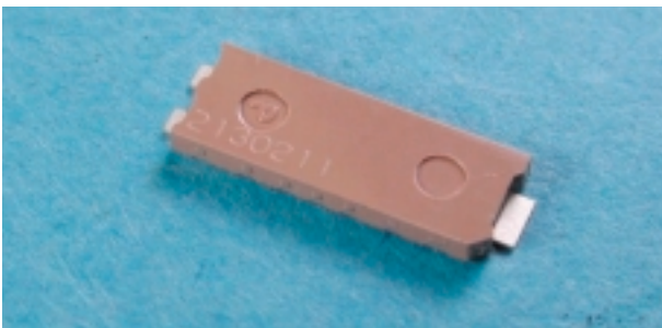
図1 アンテナの外観 Appearance of antenna
