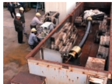
写真1 内圧破壊試験状況 Burst pressure test
