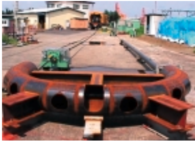
写真8 引き入れ試験状況 Laying test
