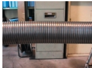
写真11 試験後のインターロック管 Appearance of interlocked conduit after laying test
