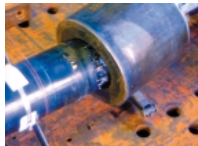
写真7 破壊状況 Breakdown point of tensile test
