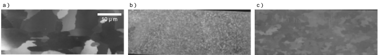
図11 フィン材のマクロ組織（ろう付加熱後） a) 本開発フィン材, b) Al-Fe-Ni-Si系合金フィン材 (DC法), c) 3000系フィン材 Macro structure of fin stocks after brazing a) New fin stock developed here, b) Al-Fe-Ni-Si alloy fin stock made by DC method, c) 3000-series alloy fin stock
