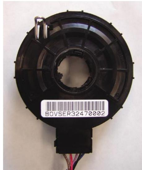
写真6 接触式舵角トルクセンサ外観
