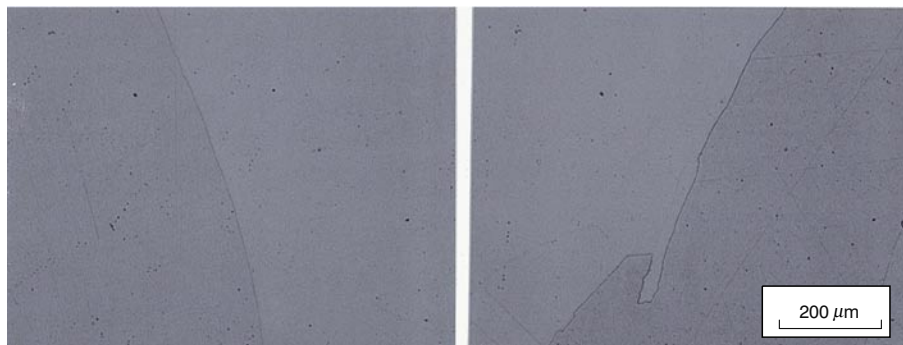
(a) 1123 K (850℃) 水素脆化試験結果 Hydrogen embrittlement test at 1123 K
