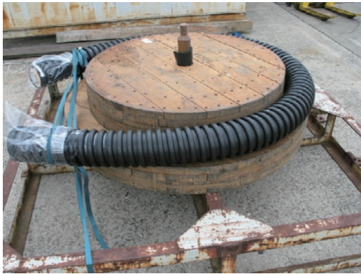
図6 曲げ評価 (φ50) Bending test.
