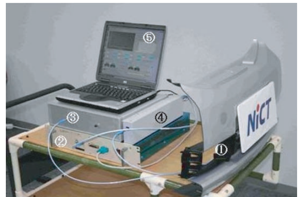
図12 UWB測距・通信同時デモ装置 (コンソーシアムで組上げたもの) Demonstration model for UWB communication and ranging.
