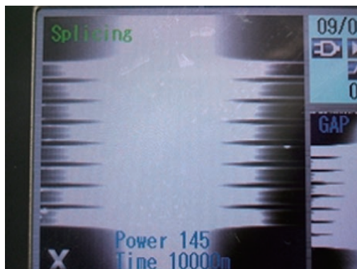
図4 自動放電強度調整 Real-time arc control.
