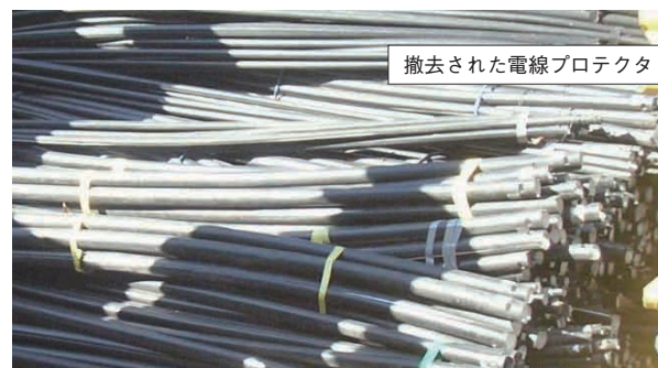
図27 撤去された電線プロテクタの例 Recovered overhead line protector.
