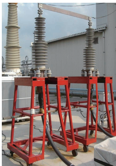
図11 77 kV用完全乾式気中終端接続部 77 kV all dry type outdoor termination.
