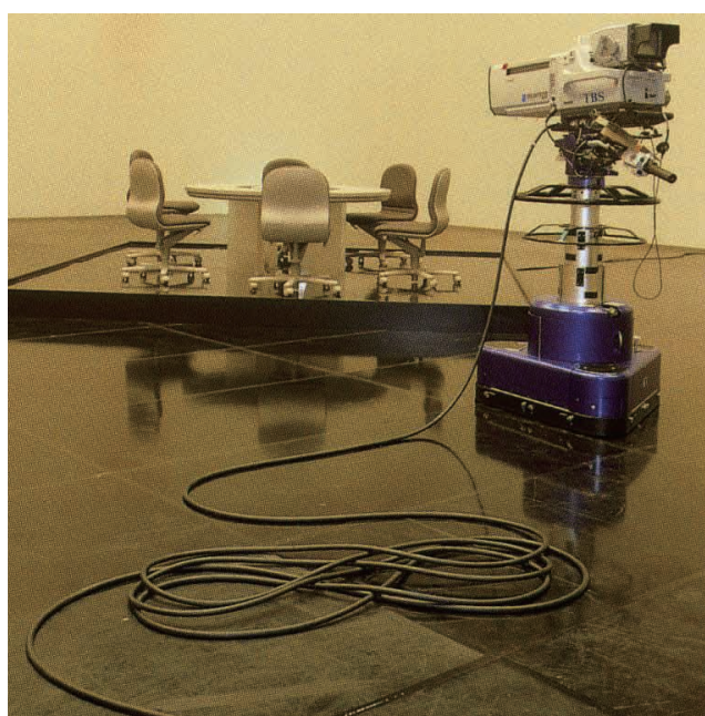
図43 光複合TVカメラケーブルシステム Optical fiber-composite TV camera cable system.
