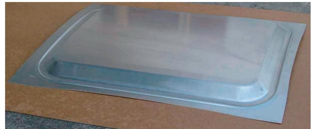
図9 6000系開発合金板の実験プレス成形品
