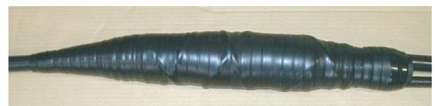
図5 Y分岐接続部の組立手順(概要)
