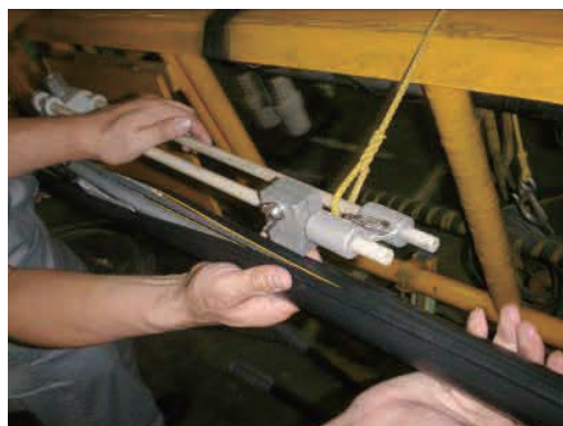
図5 専用工具による挿入作業 Insertion work using dedicated tool.
