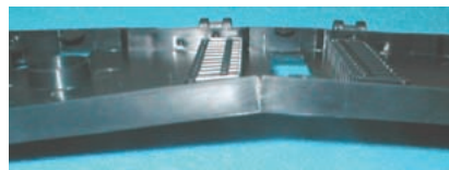
図13 スロット材50%配合時のトレイ外観 Appearance of tray using slotted core materials at 50% mixture.
