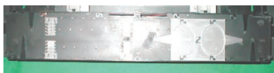
図15 後分岐接続型トレイ Mid-span entry type tray.
