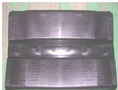
図17 シース材20%配合時のスリーブ外観 Appearance of sleeve using sheath materials at 20% mixture.
