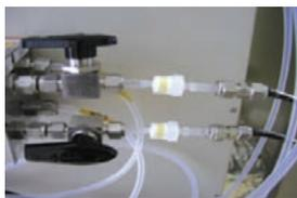
図12 アルデヒド捕集操作 (DNPHカートリッジ)
