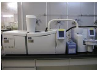
図2 加熱脱着-GC/MS (VOC測定)
