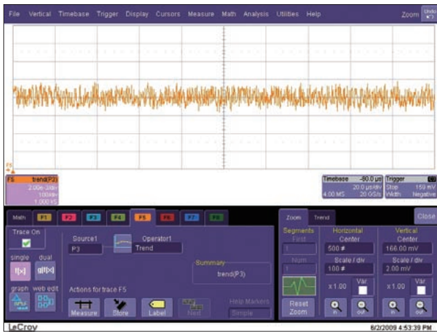
図13 バースト区間各先頭部の光平均パワーの推移 Trend chart of optical average launch power at the beginning of each burst span.
