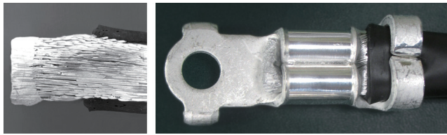
図3 超音波はんだ処理アルミ電線及び圧着状態 Ultrasonic soldered aluminium wire and crimping.
