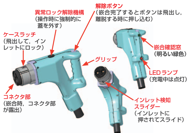
図1 コネクタ構造 Connector construction.
