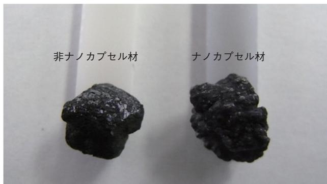
図10 燃焼後、チャー層の表面
