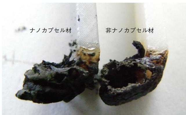
図11 燃焼後、チャー層の断面
