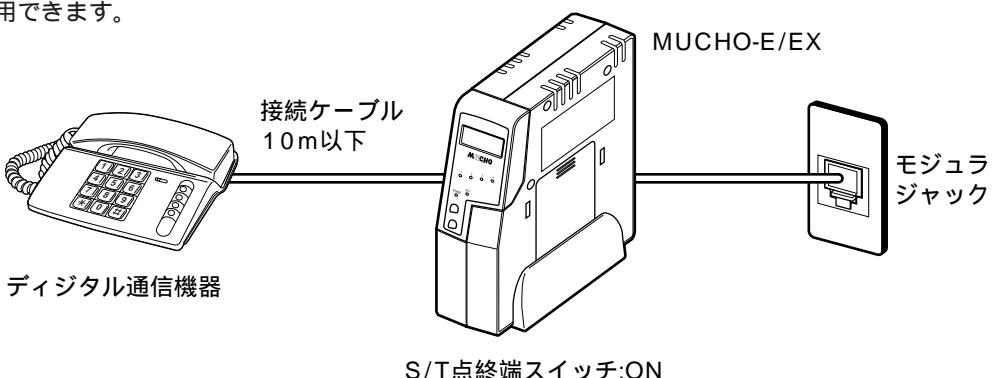
デジタル通信機器の接続が1台で、接続ケーブルが10m以上の場合、および2～7台接続する場合は、S/T点終端スイッチを「OFF」に設定してください。また、本装置から見て、デジタル通信機器接続ジャック(S/T1, S/T2)に接続した最遠端に位置するモジュラジャックには、必ず終端抵抗付きコネクタを使用してください。
