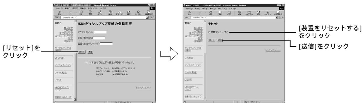
MUCHO-Eがリセットされ、その後再起動します。MUCHO-Eが再起動したら、IPアドレスを取得するためにパソコンを再起動してください。DNSアドレスの設定が必要です。プロバイダから通知されているDNSアドレスをパソコンに設定してください。
