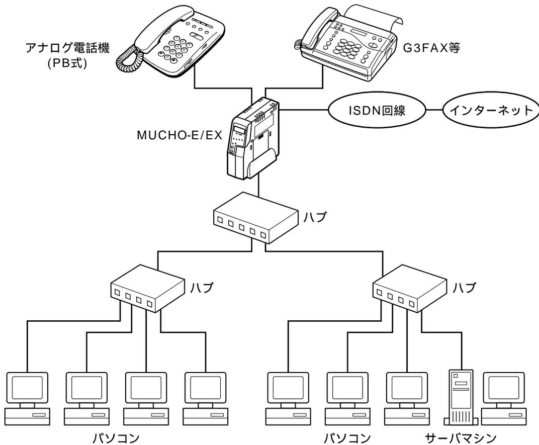
このガイドでは、ルータを使った最小限のシステムをモデルとして、インターネットにつなげるまでを解説しています。モデルとしてとりあげた最小限のシステムは次のようなものです。
