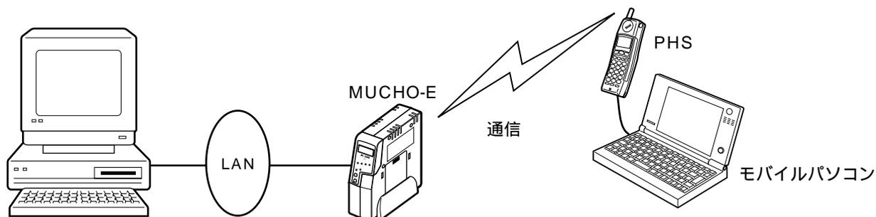
リモートアクセスを使うためには、MUCHO-Eとリモートアクセスに使うパソコン側の設定が必要です。MUCHO-Eでは、Webブラウザの設定で、ルータの[ 便利な設定 ]から[ ISDN回線接続先の登録 ]を選び、接続相手の名前、ISDN番号、サブアドレス、認証方法などのうち、必要な項目を設定します。リモートアクセス側には次の条件を満たすパソコンを使用してください。
