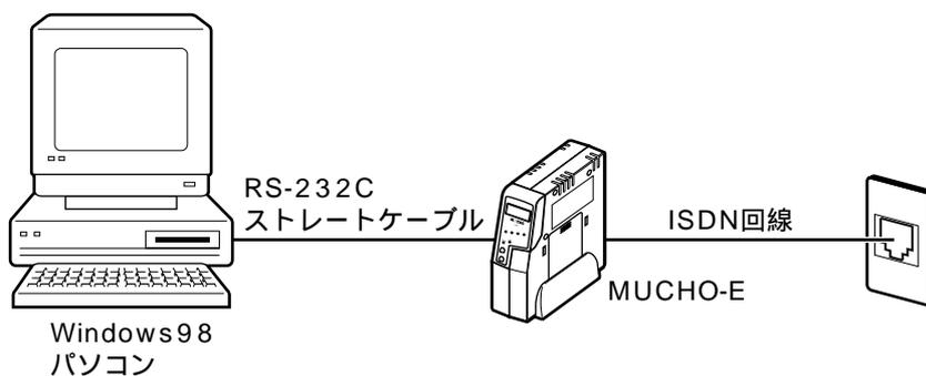
② MUCHO-EとISDN回線の接続が終わったら、MUCHO-EのシリアルポートとパソコンのシリアルポートをRS-232Cケーブルで接続します。接続にはストレートケーブルを使用してください。
