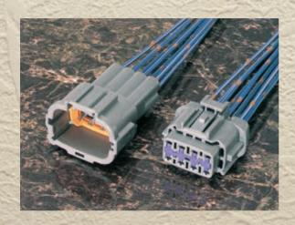
従来の防水コネクタに比べ、優れた防水性能を有し、導電率の非常に良い高信頼性端子を採用した2.3mmタブサイズ(ピッチ:5.6)の小型 多極防水コネクタです。
