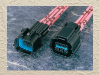
従来の防水コネクタに比べ、優れた防水性能を有し、特殊二重係止機構を採用した1.2mmタブサイズ(ピッチ: 4.5)の超小型多極防水コネクタです。
