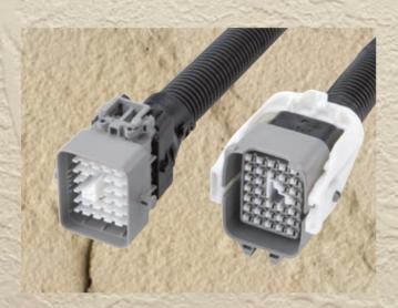
NMWP32Pコネクタは、タブサイズ 2.3mmの端子を採用し、コネクタ嵌合に関 しては、レバー機構(LIF構造)による一括ジャ ンクション方式を採用した高性能多極防水コ ネクタです。
