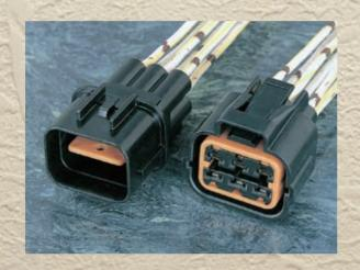
従来の防水コネクタに比べ、優れた防水性能を有し、特殊二重係止機構を採用した2.8mmタブサイズ(ピッチ: 6.8)の小型多極防水コネクタです。
