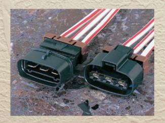
従来の防水コネクタに比べ、優れた防水性能を有し特殊二重係止機構を採用した8.0mmタブサイズ(ピッチ:11.9)のパワー回路用防水コネクタです。
