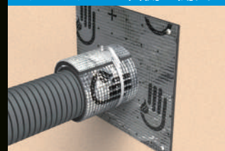
ケーブル・PF管側の開口
