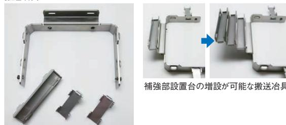
補強部設置台の増設が可能な搬送治具
