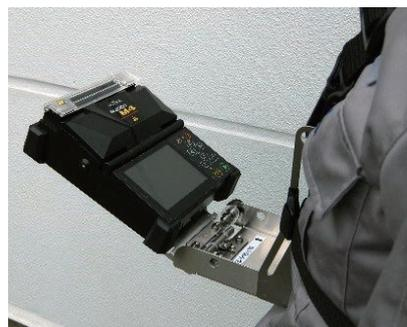
オプションのネクストラップ付き作業台(NSB-02)を使用することで、架空作業を強力にサポートします。
