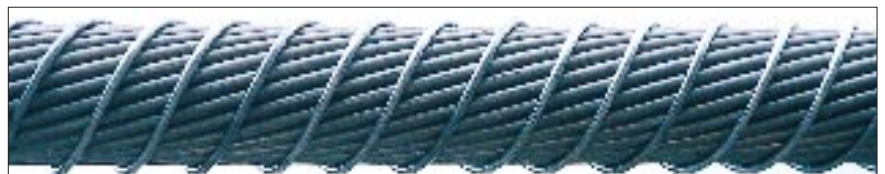
融雪線材巻付状況
