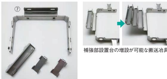
補強部設置台の増設が可能な搬送治具
