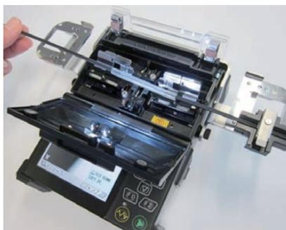
オプションの搬送治具を使用することで、ドロップケーブルの接続が、簡単・確実に作業可能です。
