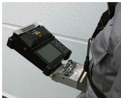
オプションのネクストラップ付き作業台(NSB-02)を使用することで、架空作業を強かにサポートします。
