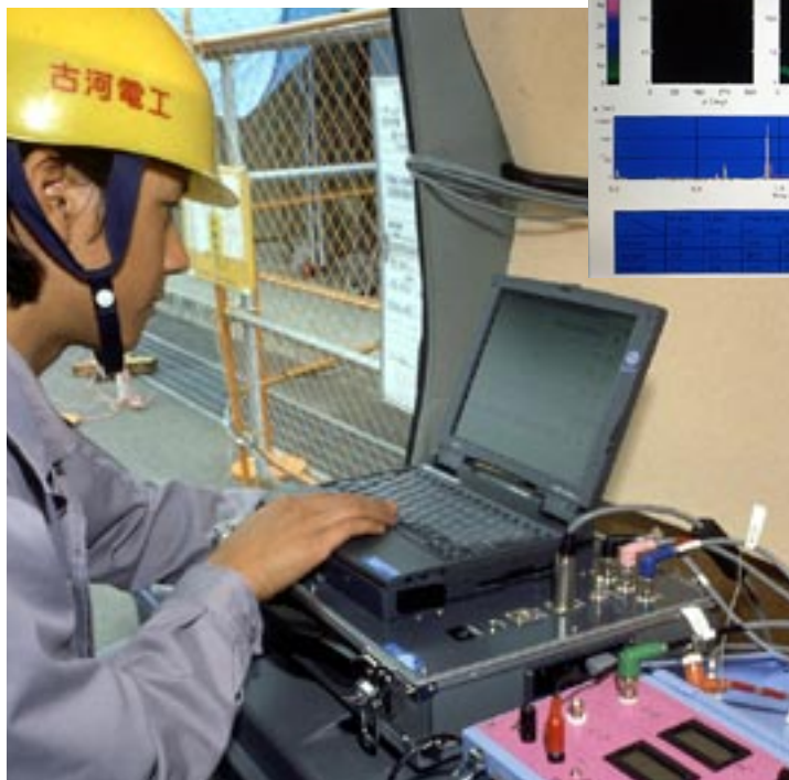
ポータブル部分放電測定システムによる測定状況
