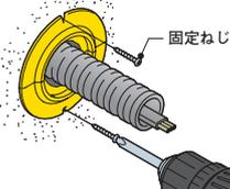
**4** パテ充填部にダンシール-Pを詰めて施工完了です。
