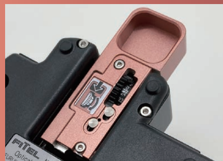
ダイヤル式で簡単に切断刃更新可能
