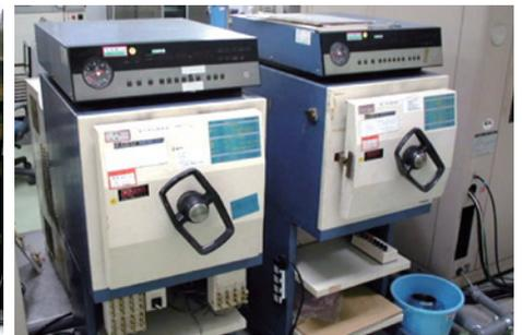
高度加速寿命試験装置
