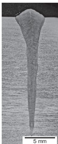
図7 SUS304 12 kW, 1 m/min加工時の試験片断面
