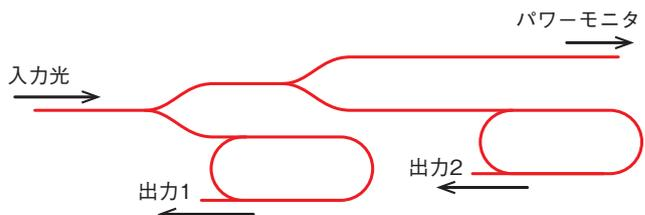
図4 PLC光回路
