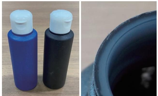
図12 複層ボトル (多層ブロー成形; 外装にアルミ付紙パックおよび古河電工にて発生する複層フィルムを使用, 内装はポリエチレン) 協力: 株式会社平和化学工業所
