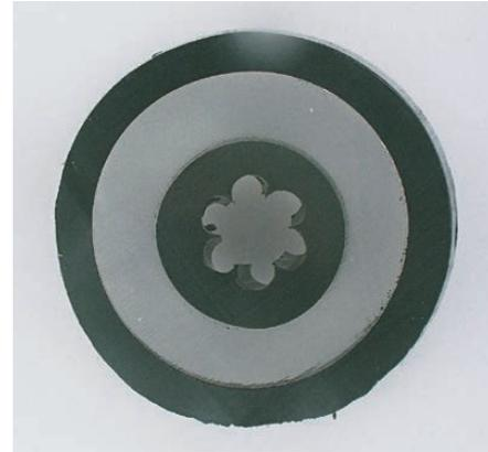
図12 ミニチュアケーブルの断面(中心の撚り銅線は抜け落ちている)
