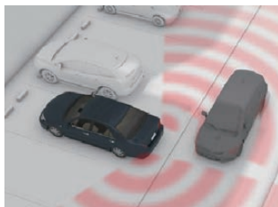
図4 周辺監視レーダ適用アプリケーション Adopted application of peripheral monitoring radar.
