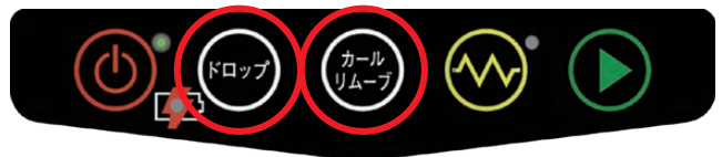
図7 ドロップボタンとカールリムーブボタン Designated function buttons.
