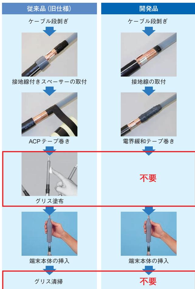
図6 作業工程比較（アイヒットニュー TS6）
