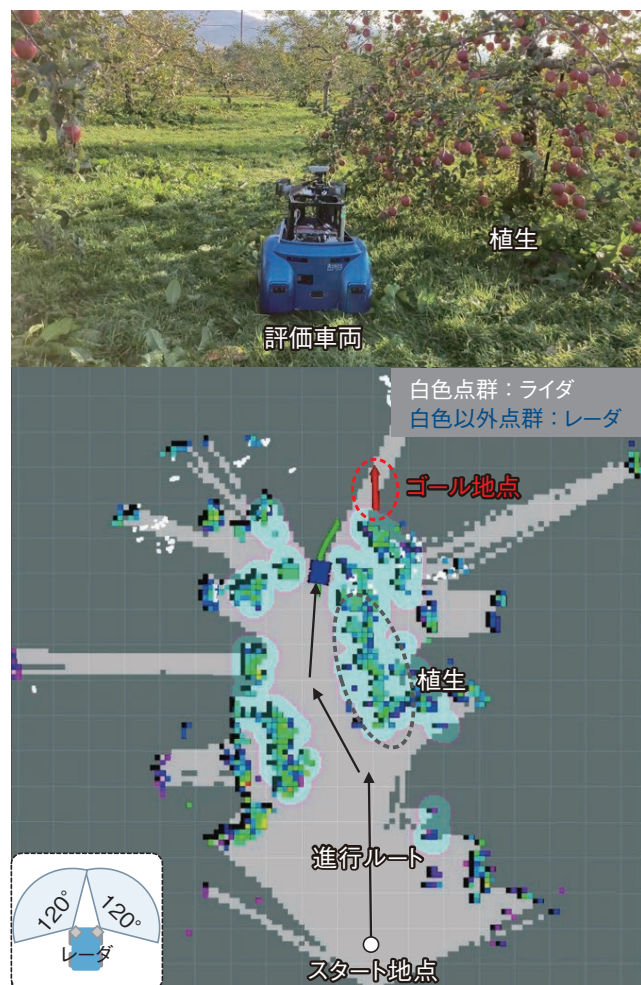
図12 レーダを用いた自動走行評価結果 Evaluation results of autonomous driving using Radar.
