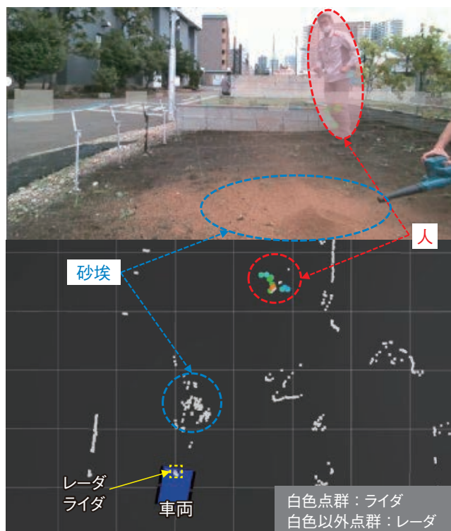
図10 砂塵環境におけるレーダとライダーの検知性能の比較結果 Comparison of detection performance between Radar and LiDAR in dusty condition.
