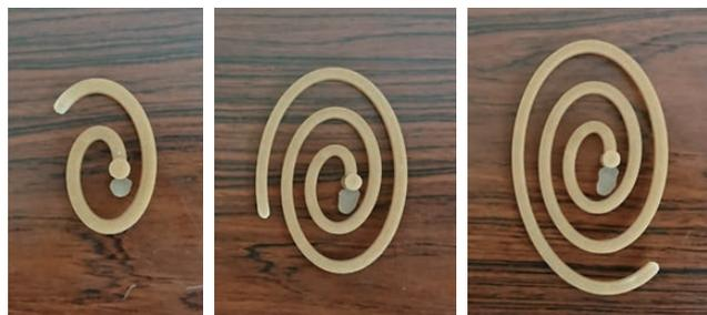
図4 CELReのスパイラルフロー試験例(左から射出圧力 50 MPa, 100 MPa, 150 MPa)
