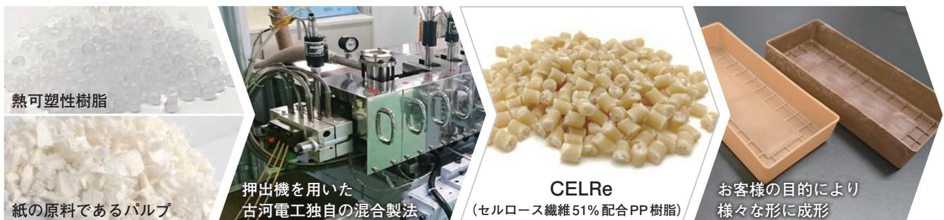
図1 CELReの製造プロセス
