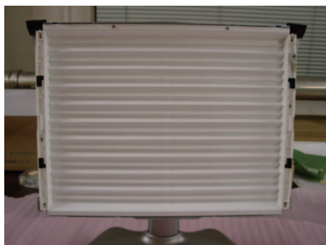
図2 山折りMCPET反射板(バックライト内部) Mountain folded MCPET reflector (inside back light).
