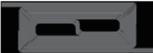
図4 伝搬損失測定に使用した回路図 Circuit layout for propagation loss measurement.
