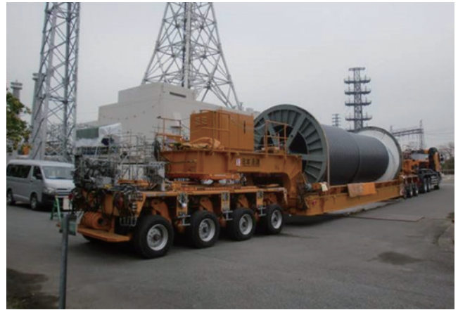
図3 長尺ケーブル輸送 Ground transportation of the ultra-long power EHV cable.
